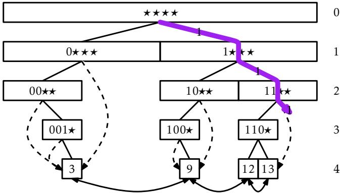
Slika 11.6: Ker na sliki ni vozlišča označenega z  $111\star$  se iskalna pot za 14 (1110) konča pri vozlišču  $11\star\star$ .
