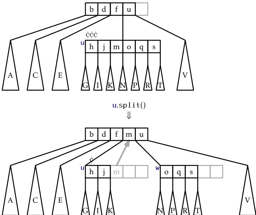
Slika 12.5: Razdeljvanje vozlišča  $u$  v  $B$ -drevesu ( $B = 3$ ). Opazimo, da se ključ  $u.keys[2] = m$  posreduje iz  $u$  njegovim staršem.
