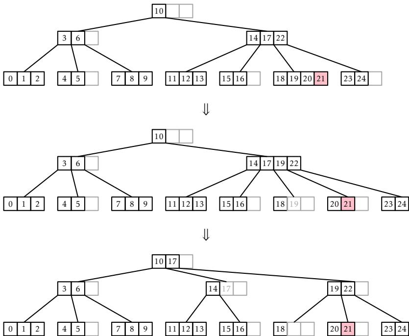
Slika 12.6: Operacija  $\text{add}(x)$  v B-drevesu. Dodajanje vrednosti 21, dva vozlišča se razdelita
