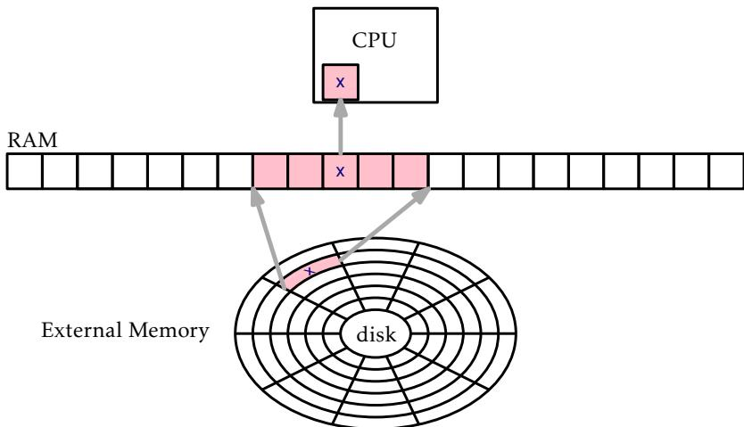
Slika 12.1: V modelu zunanjega pomnilnika, dostop do posameznega elementa  $x$  v zunanjem pomnilniku, zahteva branje celotnega bloka, ki vsebuje  $x$ , v RAM.
