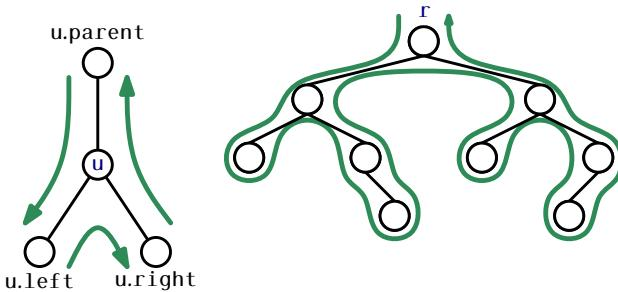
Slika 5.3: Trije primeri, ki se pojavijo na vozlišču **u** kadar obhodimo binarna drevesa, ki niso rekurzivna
