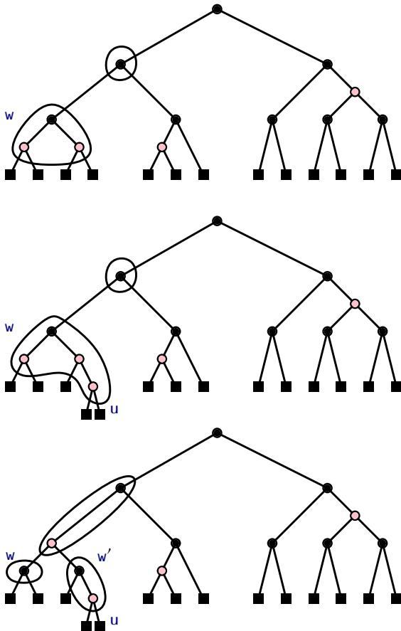
Slika 7.6: Simuliranje operacije deljenja 2-4 drevesa med dodajanjem v rdeče-črno drevo. (To simuliра dodajanje v 2-4 drevo prikazano na Figure 7.2.)
