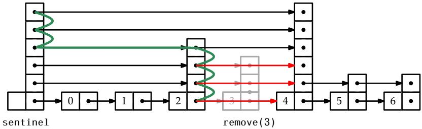
Slika 4.4: Brisanje vozlišča 3 iz preskočnega seznama.
