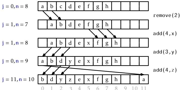
Slika 2.3: Zaporedje operacij `add(i, x)` in `remove(i)` nad `ArrayDeque`. Puščice označujejo prestavljanje elementov.
