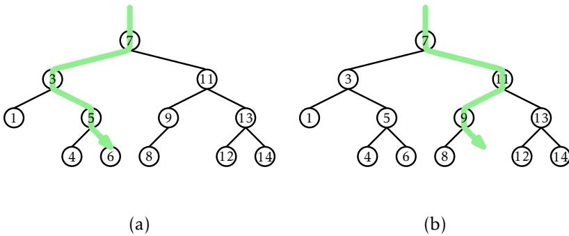
Slika 5.6: Primer (a) uspešnega iskanja (za 6) ter (b) neuspešnega iskanja (za 10) v binarnem iskalnem drevesu.
