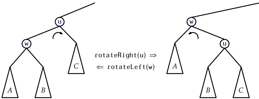
Slika 6.6: Leva in desna rotacija v binarno iskalnem drevesu.
